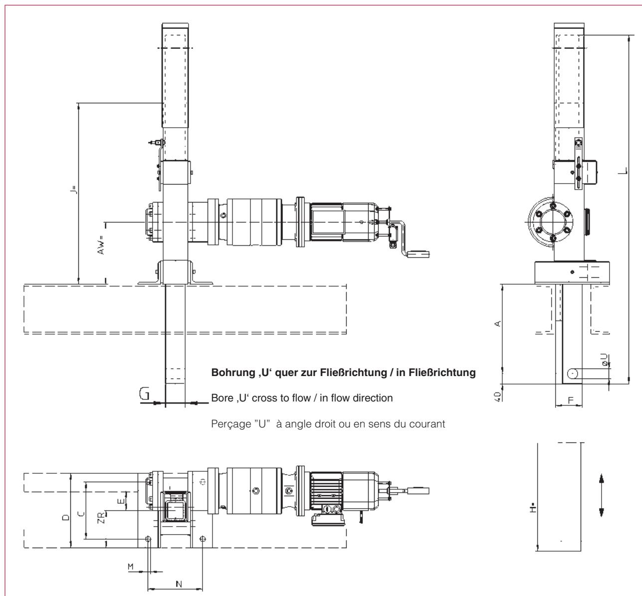
Die Abmessungen A, C, D, H, L, M, N, ZR und U werden nach Kundenwunsch angepaßt
